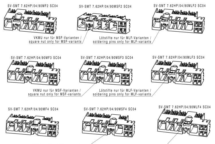
VKMU nur für MSF-Varianten / square nut only for MSF-variants Lötstifte nur für MLF-Varianten / soldering pins only for MLF-variants
